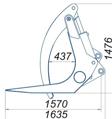
Вилы для погрузки леса - это не что иное как челюстной захват для фронтального погрузчика. Из за внешнего сходства по форме с вилами челюстной бревнозахват часто именуют как вилы для леса. Данное оборудование, установленное на погрузчик, позволяет надежно фиксировать (для перемещения или погрузки) лес-кругляк различного диаметра, веса и длины.
